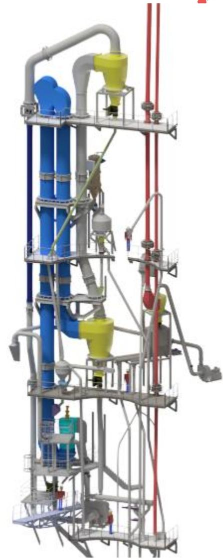
**CARBONATOR**  $\Phi$  INTERNAL = 0,3 m, VELOCITY 15 m/s
