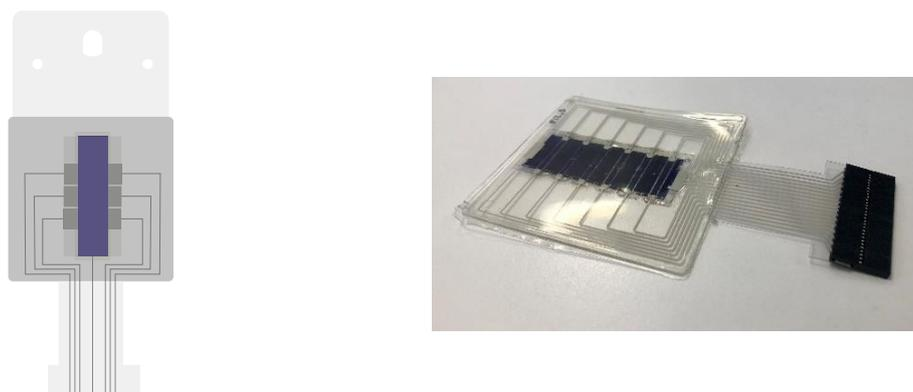
**Figura 50:** a) esquema de la configuración de la muestra inyectada. b) Foto de una muestra inyectada con TPU.
