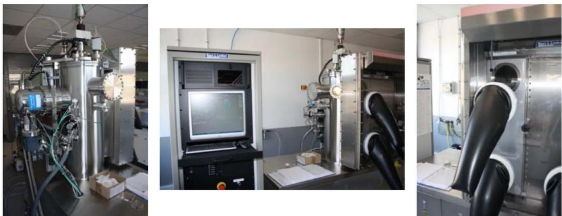
**Figura 14:** Equipo utilizado para la deposición térmica *Jurt J. Lesker*, acoplado a una caja de guantes.
