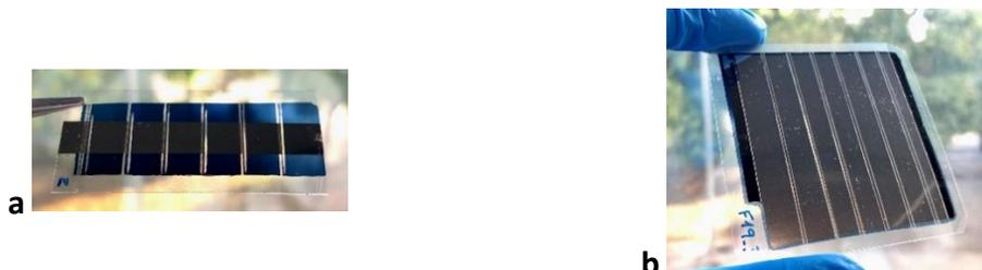
**Figura 46:** Muestras de módulos OPV sobre sustrato flexible. a) Módulo de área pequeña ( $2.67 \text{ cm}^2$ ). b) Módulo de área grande ( $17.28 \text{ cm}^2$ ).
