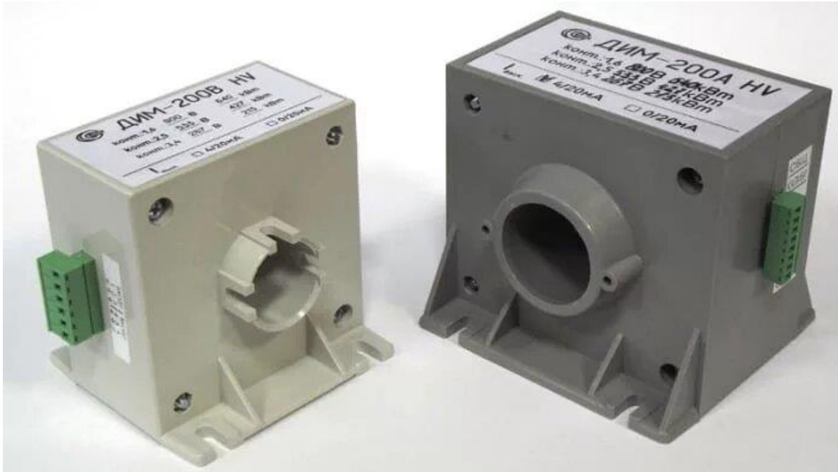
Şəkil 4. Həm dəyişən , həm də sabit cərəyanı ölçə bilən Hall effekti maqnit sensorları
