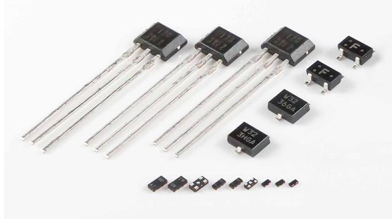
Şəkil 2. Tipik silikon Hall effekti sensoru.
