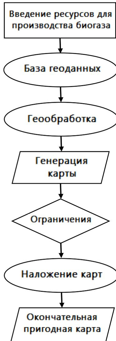
рис 1. Блок-схема описывающая этапы разработки ГИС-карты
