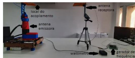
Figura 4 – Estrutura de antenas para teste.
