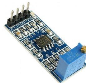
Figura 3 - Amplificador Operacional de Ganho 100X [3]
