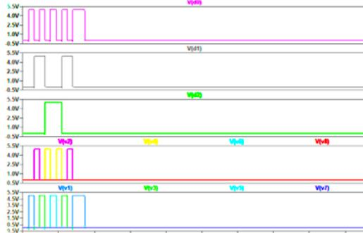
Figura 7 – Comparação das entradas V1 à V8 com as saídas codificadas D2, D1 e D0, com a alimentação de dados Vaa.
