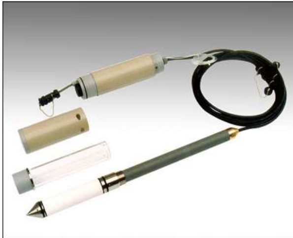
Рисунок 6 – Стационарный пьезометр, устанавливаемый в наблюдательных скважинах для долговременного мониторинга
