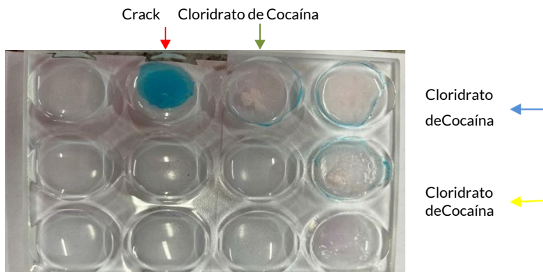
Figura 1 – Exames preliminares de amostras de cloridrato de cocaína e crack com o reagente Tiocianato de Cobalto.
