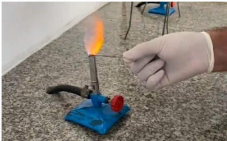
Figura 3 – Teste da chama para indicar a presença de Sódio.
