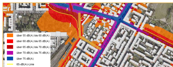
Abbildung 53: Auszug aus der aktuellen Lärmkartierung von 2017. Gelbe Markierung zeigt die Eschenstraße, welche im Bereich starker Überlärmung liegt (LH Dresden 2022b).
