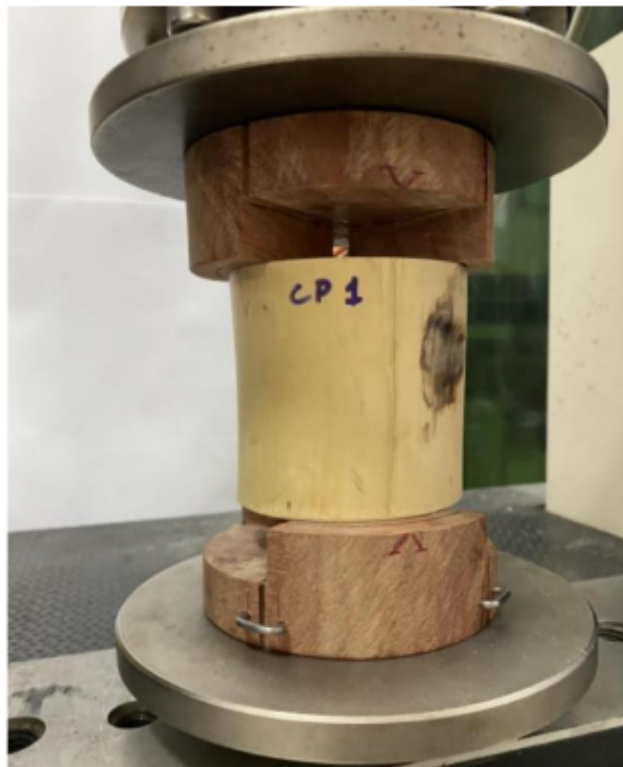
Figura 12 – Corpo de prova posicionado para ensaio de resistência à cisalhamento longitudinal
