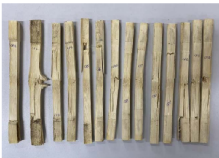
Figura 7 – Corpos de prova após o ensaio de tração
