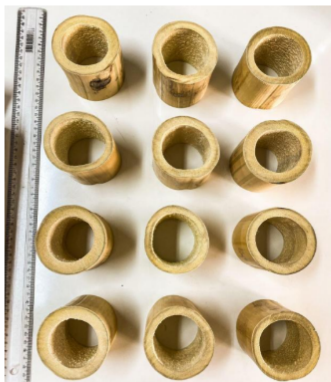
Figura 11 – Corpos de prova antes de ensaio de cisalhamento
