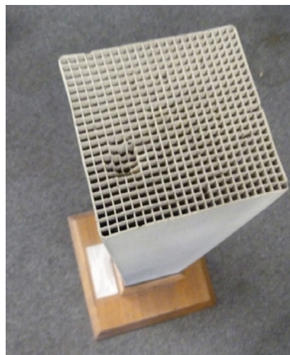
Altbach/Deizisau, HKW 1, Katalysatorelement und Kesselhaus von 1985 (Bilder: Landesamt für Denkmalpflege im Regierungspräsidium Stuttgart, Michael Hascher, 2021)
