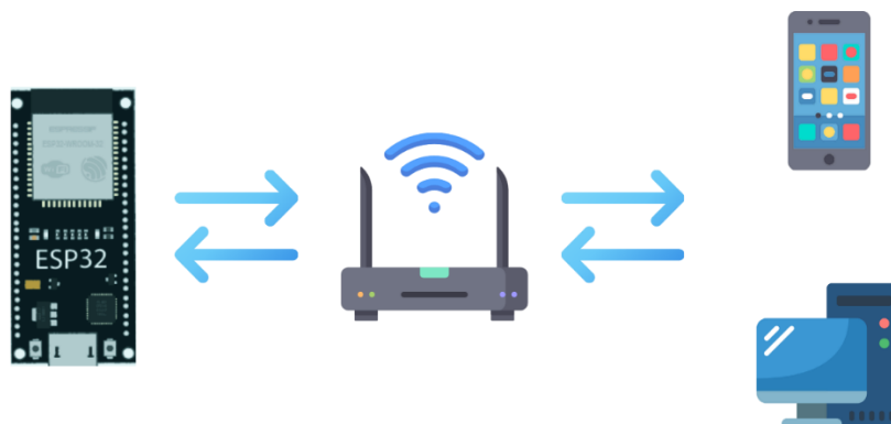
Figura 3. Funcionalidad del ESP32 de comportarse como un servidor local
