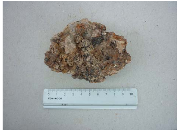
Fig.5: Iron slag (sample 88)
