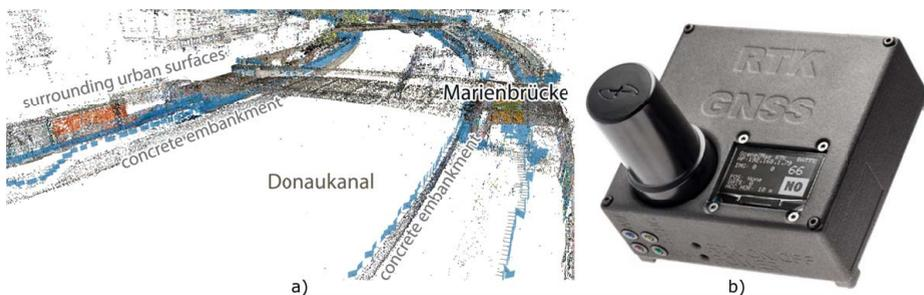
**Abb. 1:** a) Die kolorierte Punktwolke der Verknüpfungspunkte mit den Kameraorientierungen, dargestellt als blaue Rechtecke. Die Grafik wurde übernommen und adaptiert von VERHOEVEN et al. (2022); b) die (RTK) GNSS/IMU-Hardwarelösung (WIESER et al. 2022).
