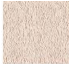
Штукатурка Ceresit CT 35/ CT 30, получена путем круговых затираний пластиковым полутерком (теркой)
