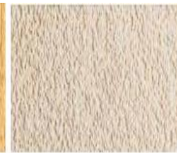
Штукатурка Ceresit CT 137, получена путем затирания пластиковым полутерком (теркой).
