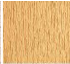
Штукатурка Ceresit CT 35 / CT 30, получена путем затираний пластиковым полутерком (теркой) в одном направлении
