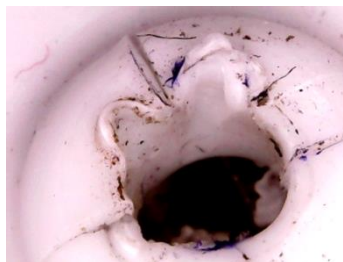
Изображение № 3. Вид повреждений от предметов с заостренной и тупой рабочей поверхностью.
