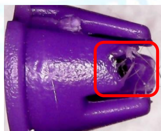
Изображение № 4. Цанга со следами криминального воздействия.
