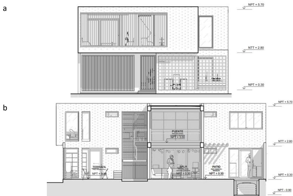
Nota. El gráfico presenta: (a) Elevación Frontal, (b) Elevación corte lateral derecha.
