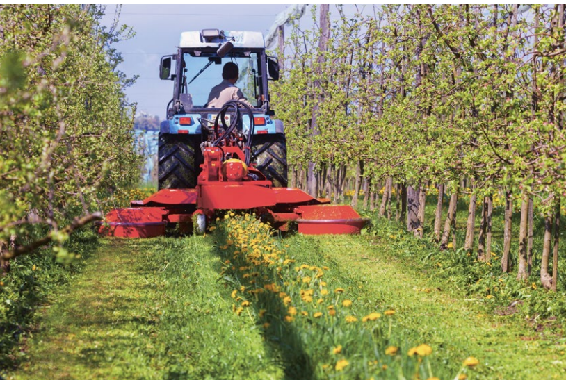
Мульчеры, приспособленные для ухода за полосами цветущих дикорастущих трав (на рисунке модель «Humus OMB®» с боковой разгрузкой), позволяют эффективно ухаживать за междурядьями, защищая при этом растения на полосах.
