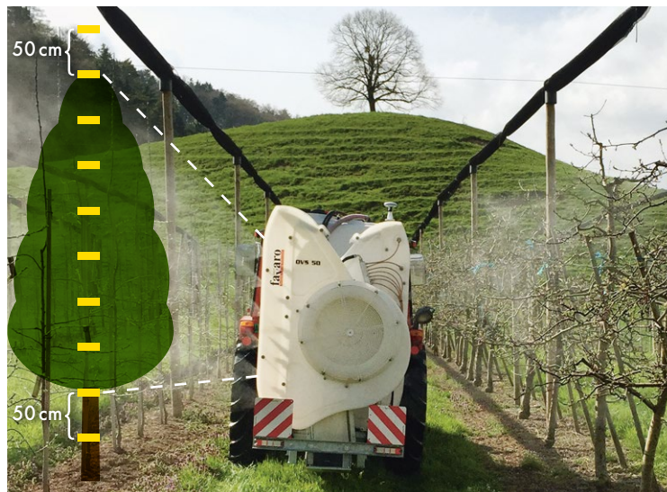
Оптимальное направление воздушной струи и степень покрытия можно проверить с помощью водочувствительной бумаги внутри кроны дерева, над и под ней.
