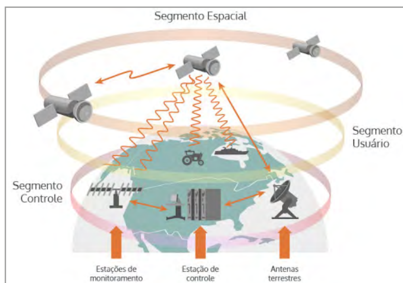
Figura 24 – Segmento Espacial, de controle e do usuário que compõem a constelação GPS.
