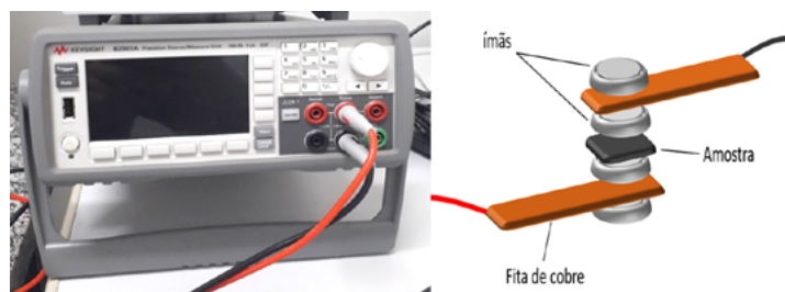
Figura 8 - Equipamento utilizado para as medições simultâneas de I \times t e V \times t das amostras (esquerda). Modelo representativo da estrutura utilizada durante os ensaios eletromecânicos com as amostras de rGO/PVDF (direita).
