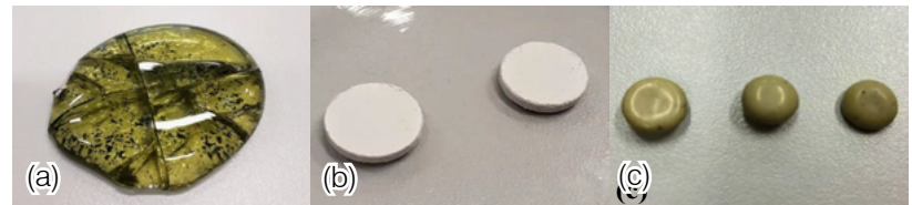
Figura 6 - (a) Vidro; (b) Pastilhas do pó de vidro; (c) Vitrocerâmica contendo a fase Wollastonita.
