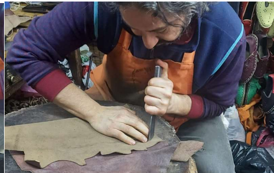
Fotoğraf 2. Kırba şablonunun çizilmesi
