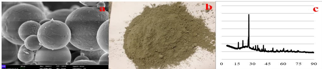
Şekil 1. Uçucu Kül (a) FESEM görüntüsü, (b) fiziksel görünüm, (c) XRD grafiği
