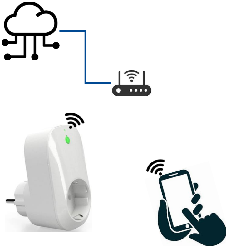
WLAN-Steckdose, sog. Smart Plug (mit Steuerung über Cloud und App)
