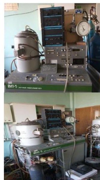
1-rasm. Nanometrlar tartibida qalinligi bo‘lgan qatlamlarni olish uchun asbob-uskunalar - vakuum tizimi, magnetron tizimi, yuqori chastotali generator va tayanch isitgich.
