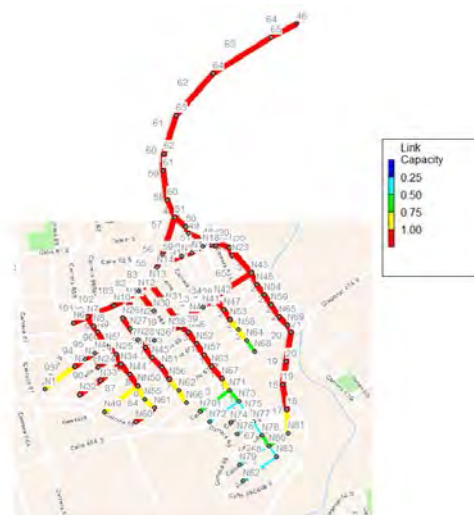
Figura 5. Reflujo red de alcantarillado pluvial caso 2
