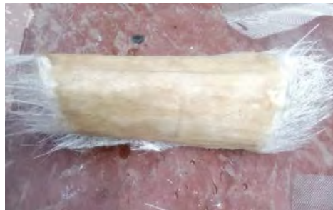
Figura 10. Conformado por capas de fibra de vidrio
