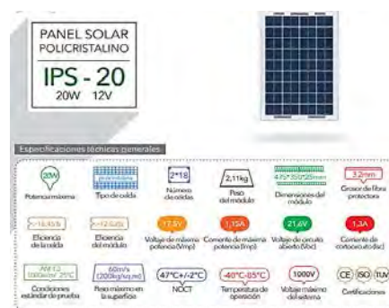
Figura 10. Panel Fotovoltaico Policristalino de 20W-12V [10]
