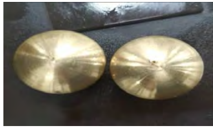
Figura 4. Electrodo construido bajo las especificaciones del estándar ASTM D1816
