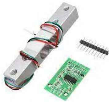
Figura 3. Celda de carga de 5kg y conversor HX711
