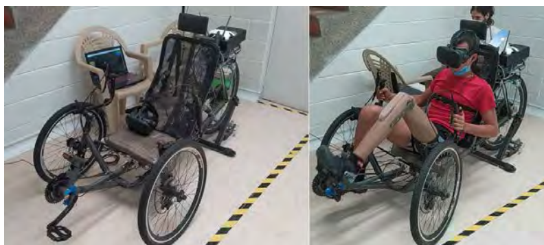
Figura 1. Sistema diseñado por el grupo GIBIC para rehabilitación de personas con amputación de miembro inferior: a) Vista completa del simulador, b) Paciente usando el sistema con las gafas de realidad virtual
