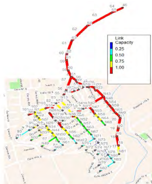
Figura 9. Reflujo red de alcantarillado pluvial caso 3
