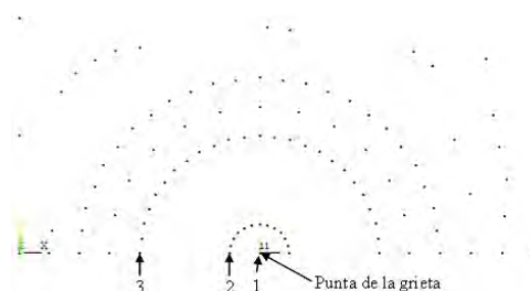
Figura 4. Especificación de la ruta a lo largo de la cara de la grieta
