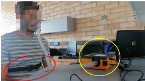
Figura 11. Calibración del sensor de respiración con FLUKE VT650. En rojo sensor de respiración desarrollado y en amarillo el patrón de medición FLUKE VT650. Durante la prueba el sujeto inhala y exhala de forma controlada. El patrón detecta cambios en el flujo, mientras el sensor detecta cambios en el volumen del tórax durante la respiración
