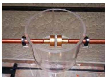
Figura 2. Recipiente construido para la realización de pruebas de tensión disruptiva
