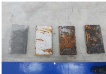
Figura 16. Probetas tras 3.000 horas
