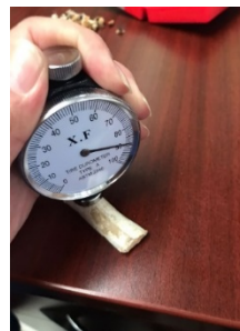
Figura 4. Evaluación de dureza con durómetro portátil
