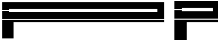
Figura 1. Layout de sensores rectangulares: a) 44 mm, b) 12 mm
