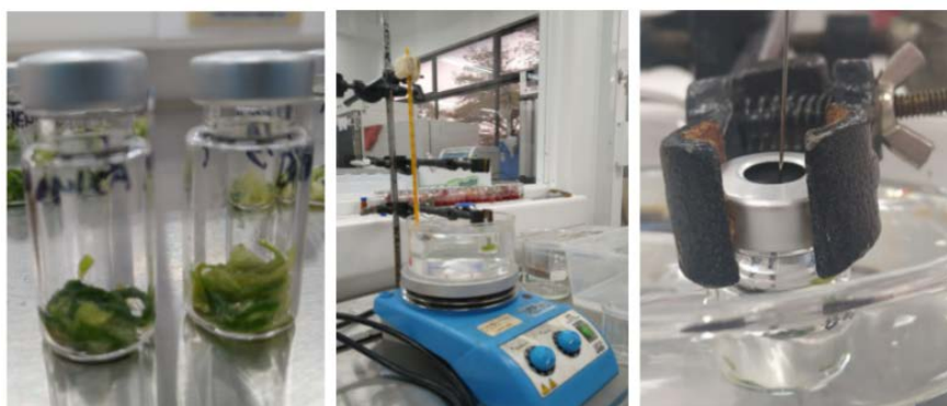
Figura 3. Montaje microextracción en fase sólida HS-SPME
