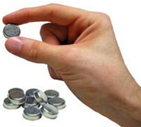
Mynd 1 iButton hitanemar sem notast var við í tilrauninni til þess að fylgjast með hitastigsbreytingum afurða á umhverfis.
