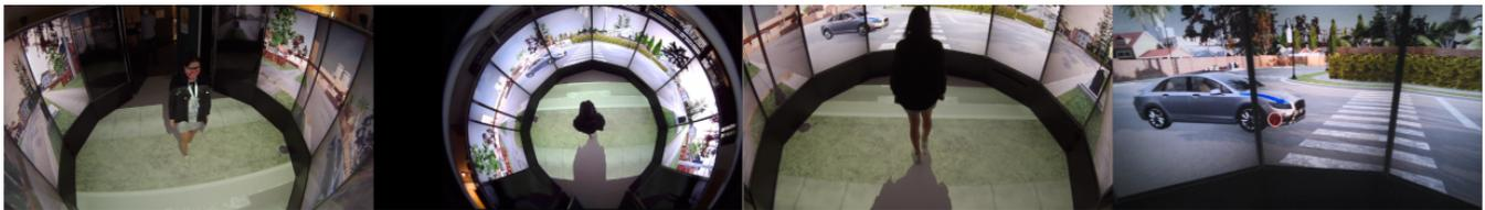
**Figure 1: Environnement de simulation pour observer des piétons lors de la traversée d'une route face à un véhicule entièrement autonome.**
