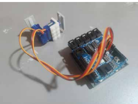
Figura 9. Vista del prototipo desarrollado para conectar dos servomotores a una placa Arduino y a bloques de construcción.
