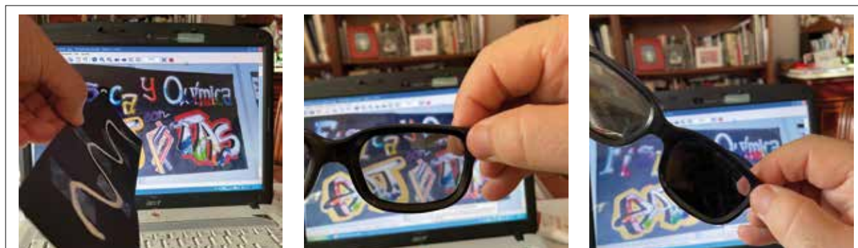
Figura 6. (a) La luz de la pantalla está linealmente polarizada ( 45^\circ ) (6) Si se interpone un polarizador (gafas 3D) se ve la luz que emite la pantalla. (6) Si se coloca el polarizador cruzado, no se ve.
