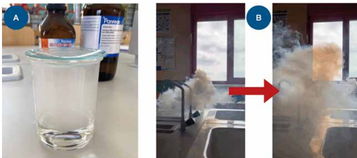
Figura 2. A. Recreación del experimento de Tissandier; con formación lenta del cloruro de amonio. B. Formación rápida del cloruro de amonio por contacto directo de disoluciones acuosas de cloruro de hidrógeno y amoniaco. Nótese la importante generación de humo en esta última.
