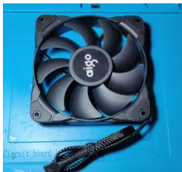
Fig. 8: Ventilador de PC usado para mover el aire.
