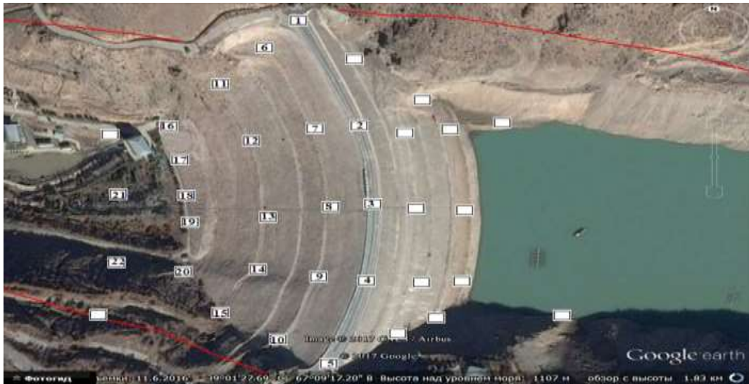
2-rasm. Hisorak suv omborida seysmometrlarning joylashuv o'rnini
