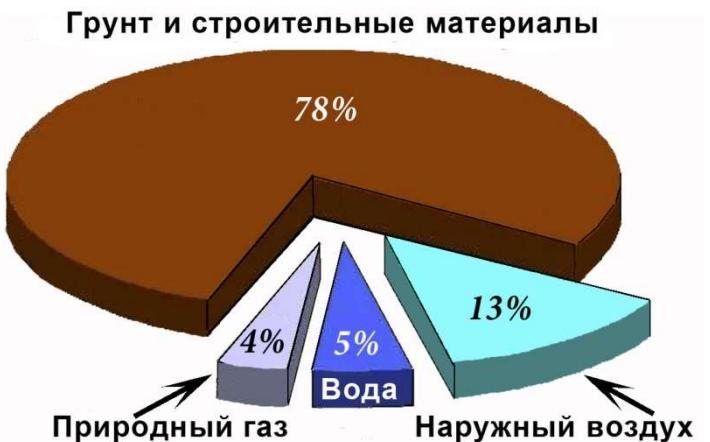
Рисунок 1 – Вклад радона в пространство помещения из разных источников
