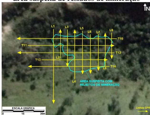
Figura 25 - Perfis GPR na área suspeita de resíduos de mineração
