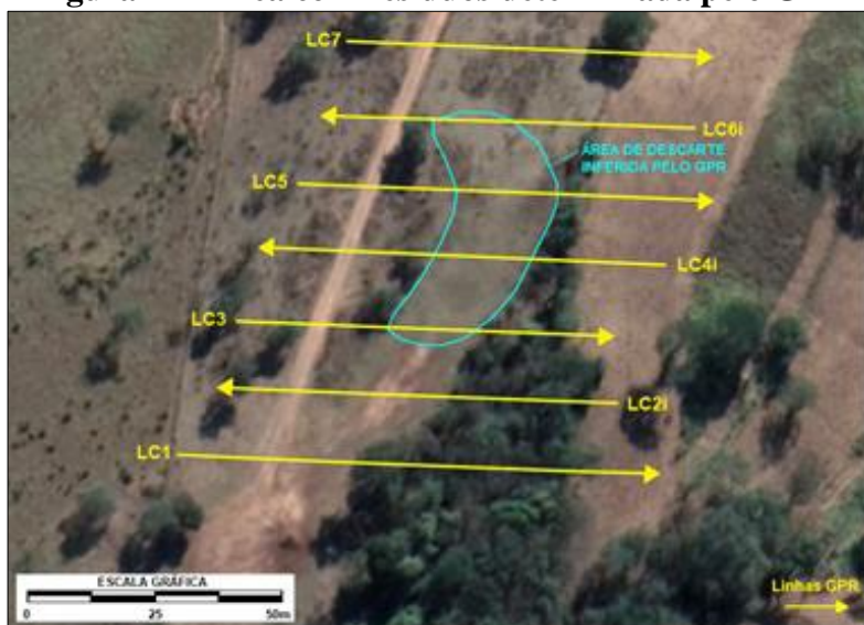
Figura 21 - Área com resíduos determinada pelo GPR
