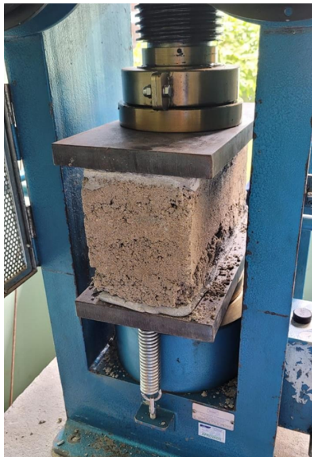
FIGURA 7 – BLOCO NA PRENSA HIDRÁULICA
