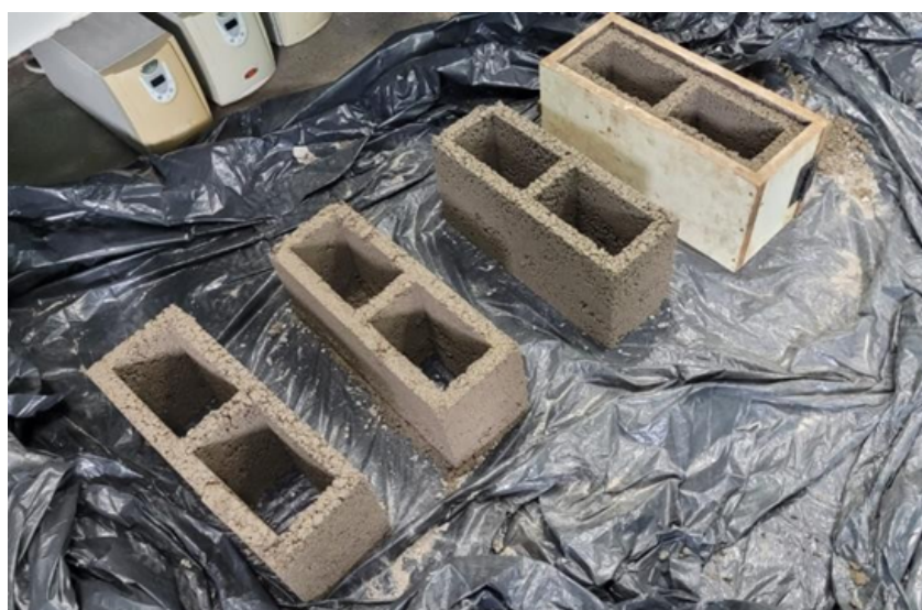
FIGURA 4 – BLOCO APÓS RETIRADO DA FORMA
