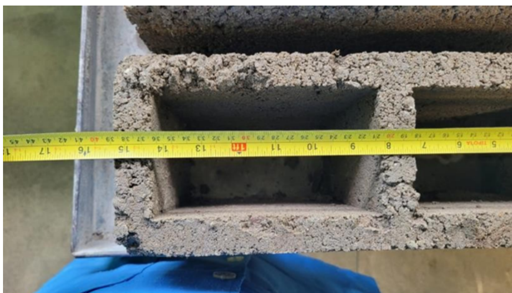
FIGURA 6 – ANÁLISES DIMENSIONAIS DOS BLOCOS
