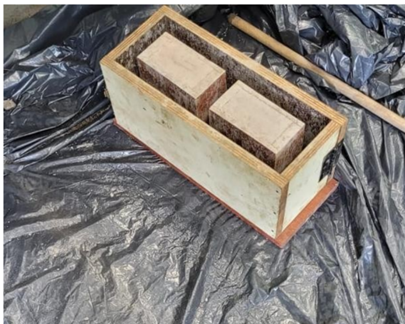
FIGURA 3 – FÔRMA DO BLOCO DE CONCRETO
