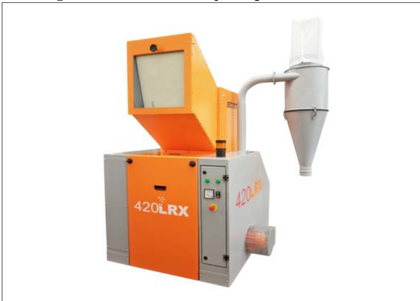
Figura 3 - Moinho Destroçador para Corte de PET
