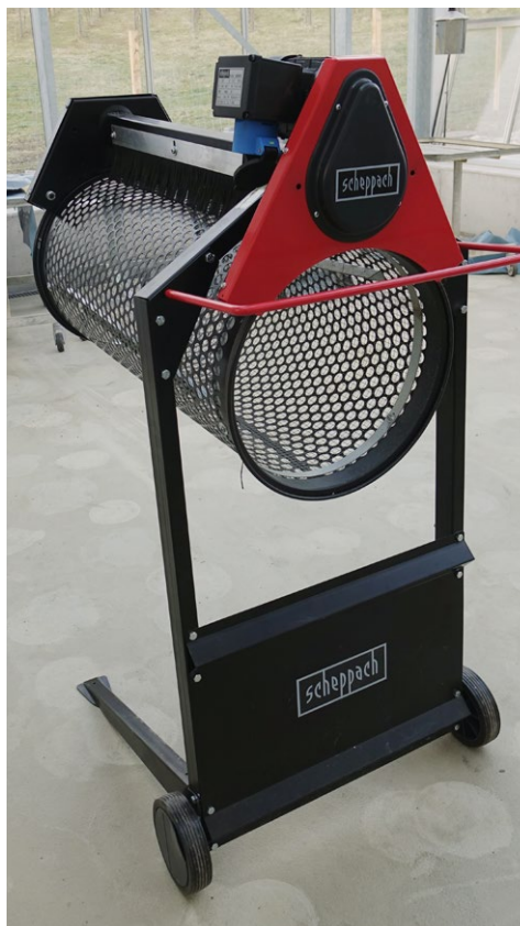
Rotori për përzirjen e kompostit ose substratit final
