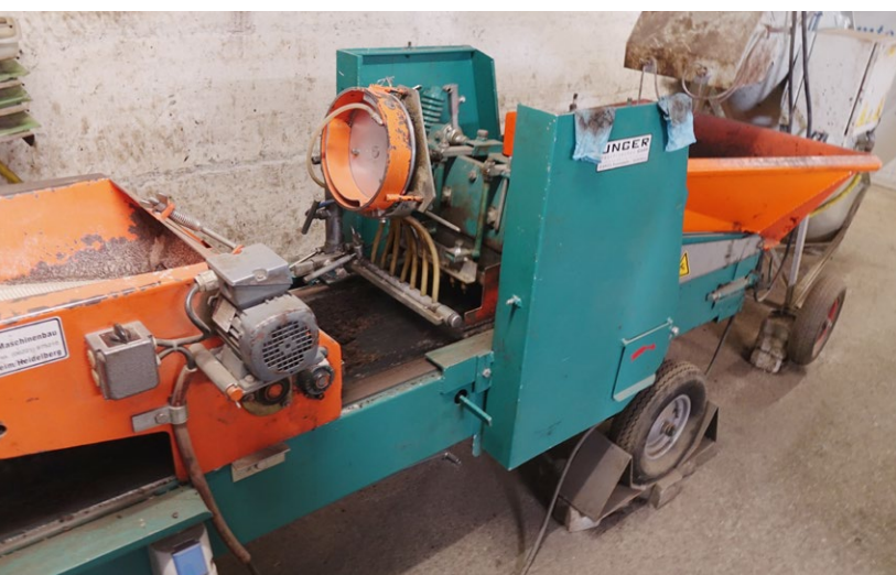
Linjë kompletet për fidane me mbjellës pneumatik
