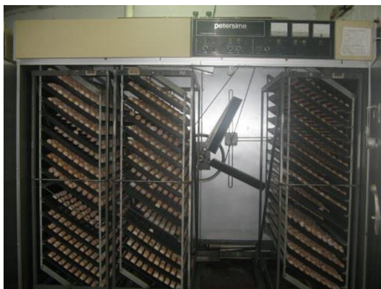
Figura 8. Máquina de incubação realizando viragem dos ovos.
