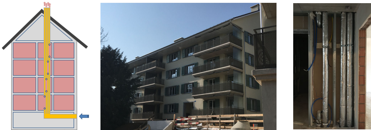
Abbildung 1 Links: Prinzipskizze der Schwerkraftlüftung für innenliegende Bäder/WC. Mitte: Mehrfamilienhaus mit Monitoring der Schwerkraftlüftung, Neubau Bezug 2022 (© INEB). Rechts: Lüftungsrohre im Erdgeschoss für die Schwerkraftlüftung in den innenliegenden Bädern (© Ferrara Architekten).
