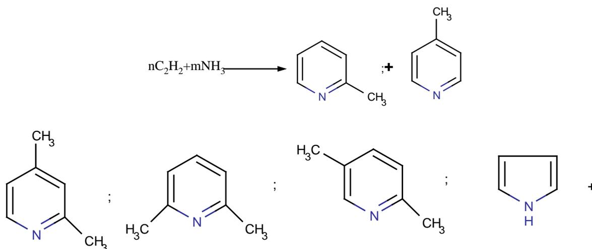
Избирательность процесса зависит от природы применяемых катализаторов. В зависимости от их характера процесс можно направить в сторону образования либо ацетонитрила, либо смеси 2- и 4-метилпиридинов с небольшой примесью других компонентов.
