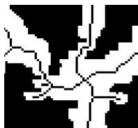
Figura 13. Imagen esquelizada superpuesta a la imagen dilatada.
