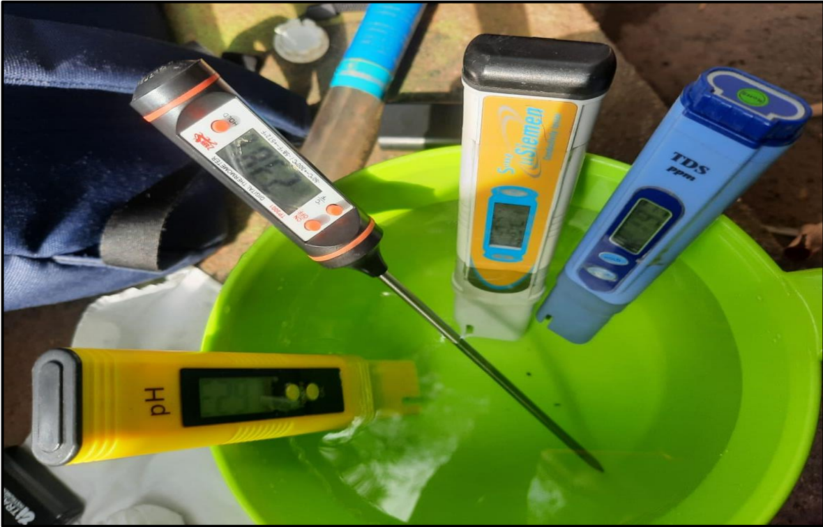
Dokumentasi Pengukuran Parameter Fisik Air (TDS, DHL, pH, Suhu)
