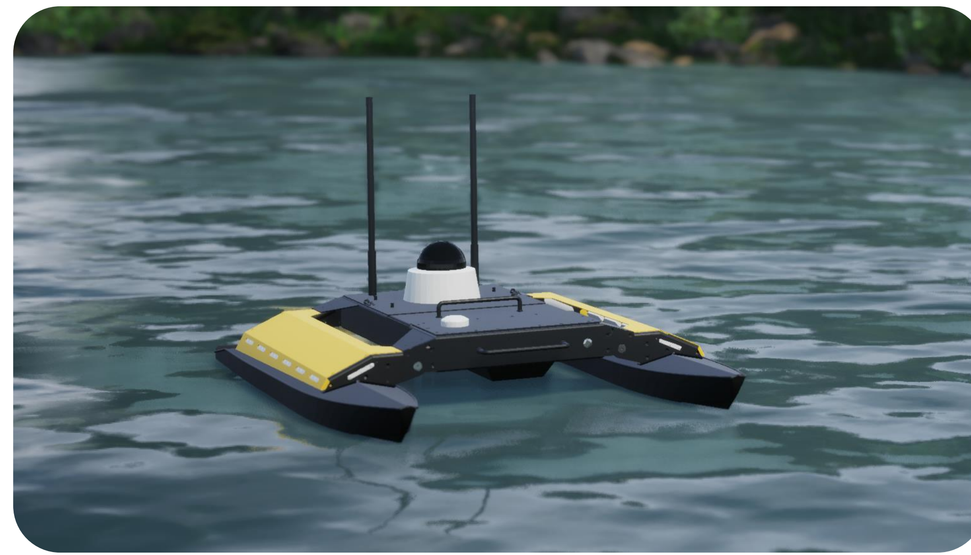
3D-Modell des Schwimmroboter „Elisabeth“ basierend auf einem Katamaran von Clearpath Robotics [S.Reitmann / TUBAF]
