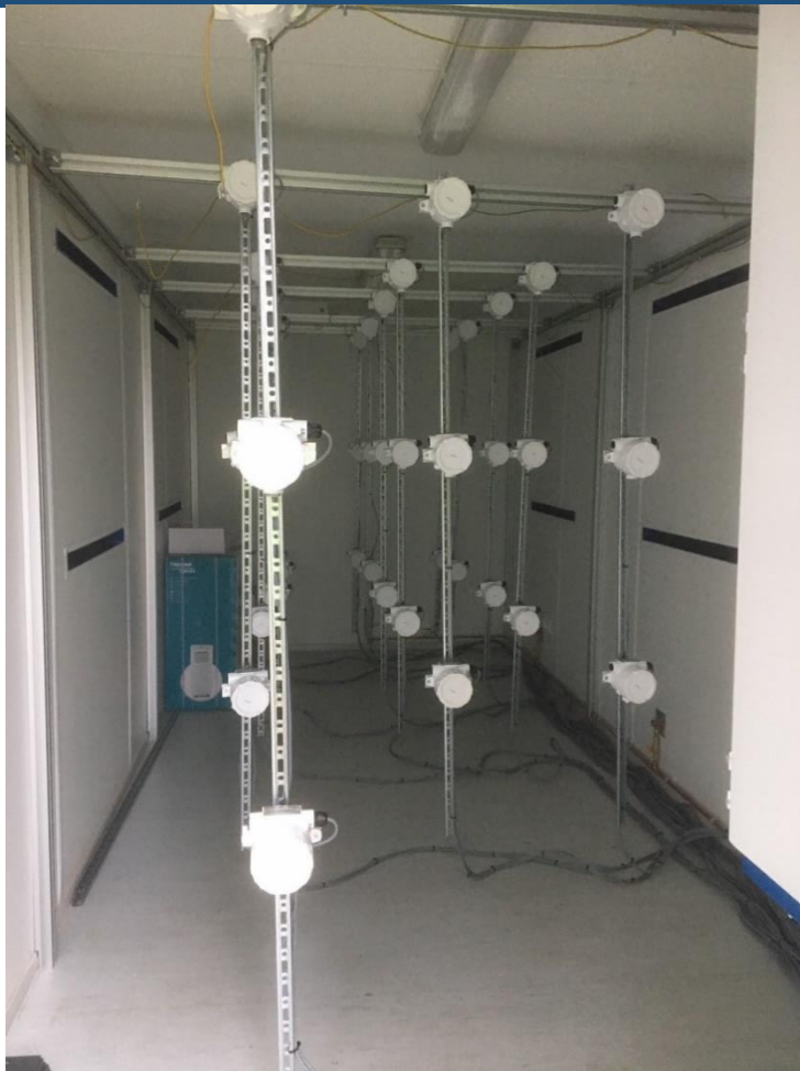
Figuur 9 Matrix van sensoren aan de binnenkant van de container
