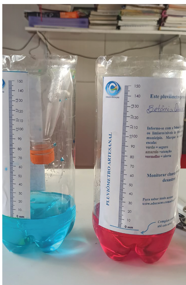
Figura 18 - Exemplo de pluviômetro artesanal de garrafa PET
