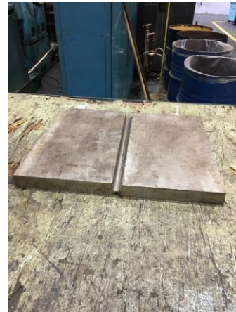
Figura 1 – Chapa de Aço Inox preparada para a solda (Chanfro duplo U)
