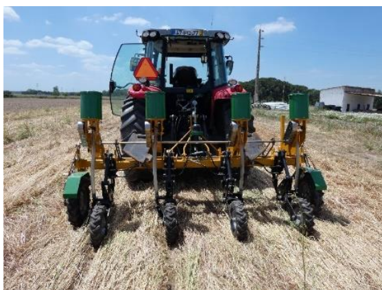
Figura 3 (acima): Sistema de sementeira direta. Sementeira numa espessa camada de cobertura fornecida por uma cultura de cobertura rolada por um rolo-faca (Basch, 2018)
