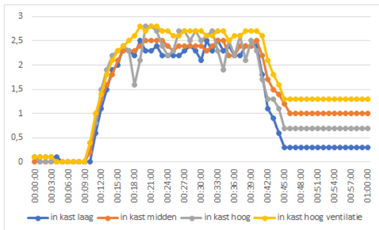
Figuur 83. Concentratie (vol % CH 4 ) in het 4m 3 kaststation bij een lekdebiet van 3 m 3 /h (windluw)
