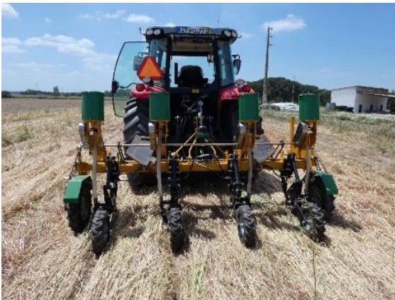
Abbildung 3: Direktsaat-System. Aussaat in eine dicke Mulchschicht, die durch eine angewalzte Deckfrucht gebildet wird (Basch, 2018)
