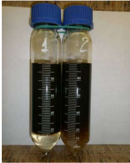
Şəkil 1. Depressantın Sanqaçal yatağından olan neftdən suyun ayrılmasına təsiri
