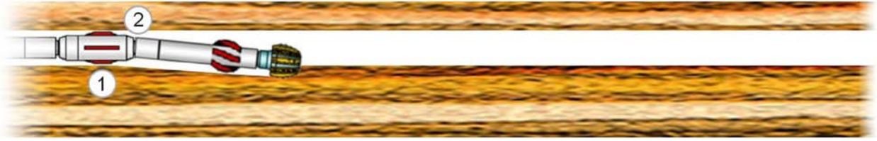
Şəkil 3. Yan lülənin qazılması addım 1.
