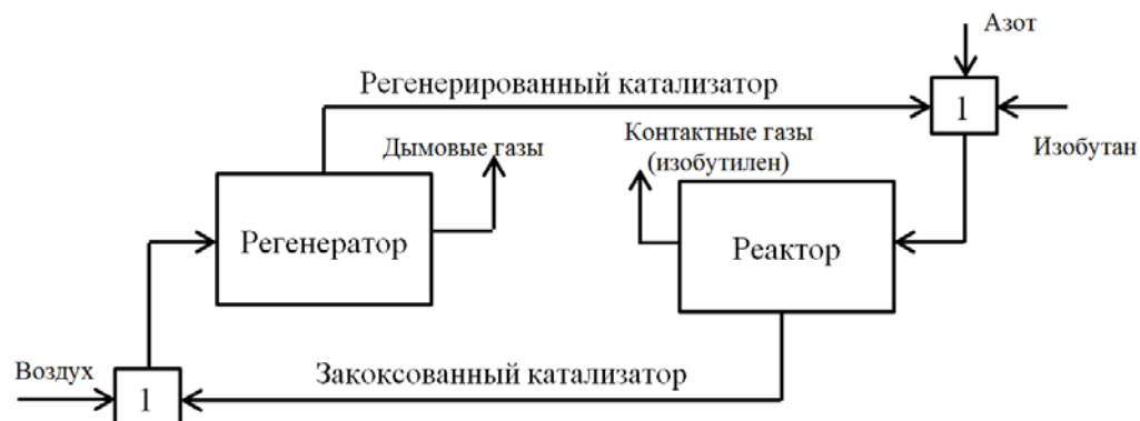
Рисунок 1. Структура материальных потоков в циркуляционной системе реактор-регенератор
